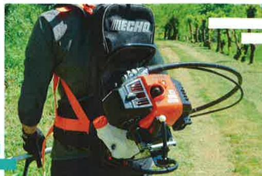
**Machine équipée d'un harnais grand confort.** Moteur fixé sur un cadre selon un axe de 35° permettant de garder son centre de gravité proche du dos de l'utilisateur réduisant ainsi la fatigue lors de l'utilisation.
