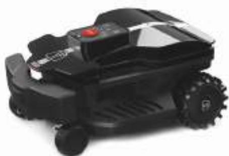
Le modèle X2.9 est conçu pour les espaces verts de moyennes à grandes dimensions. Les deux modèles de la gamme, D et L, sont équipés d'une technologie avancée qui confère au robot des performances élevées. Des moteurs sans balais, des batteries puissantes et une lame de 29 cm permettent au robot de gérer des zones allant jusqu'à 3 500 m<sup>2</sup>.
